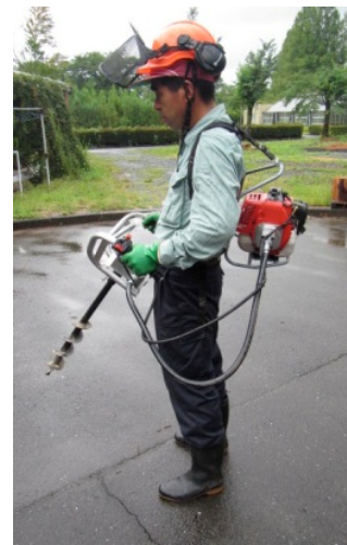
写真-3 コンテナ苗用穴掘り機
