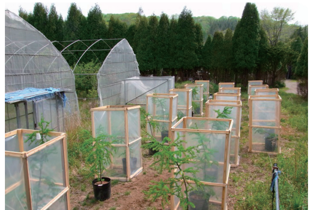
写真-3 上部を開放しチャンバーでの加温の様子
