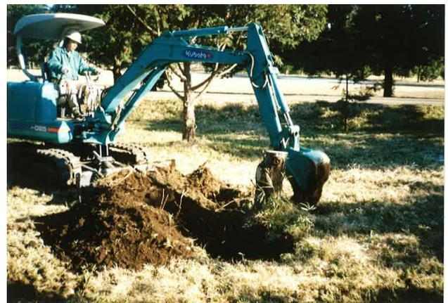
写真-4 重機による植え付け穴の準備。茨城県林業技術センター提供。
