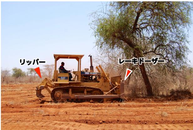
写真-2 レーキドーザー付きトラクターによる整地。後部にはリッパーが取り付けられている。
