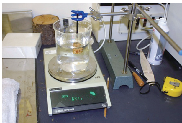
写真-5 水置換法による体積の測定
