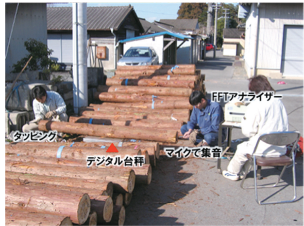
写真-6 タッピング法によるヤング率測定
