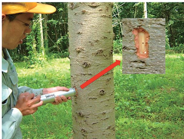
写真-4 ピロディンによる樹幹陥入量の測定
