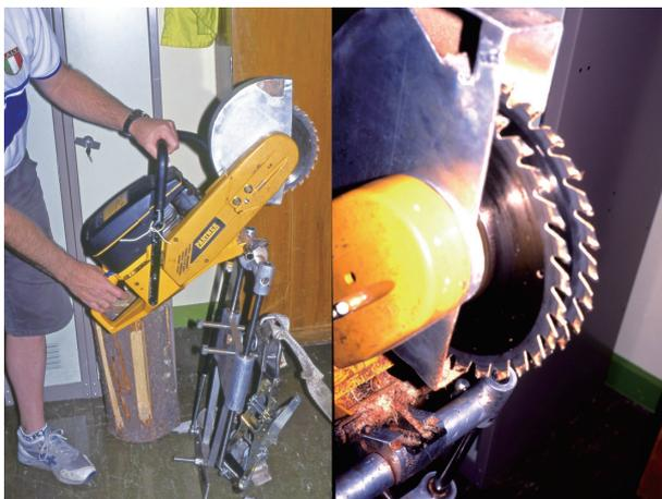
写真-2 エンジンツインソーによるサンプル採取機
