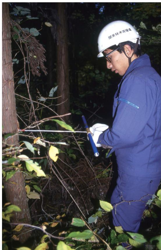
写真-1 成長錐によるサンプルの採取
