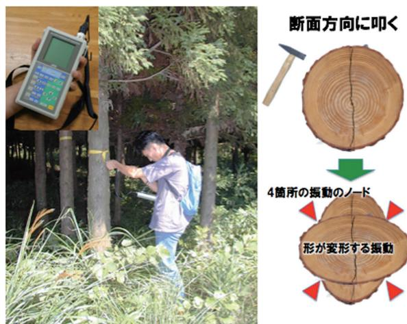
図-3 横打撃による振動の模式図と測定の様子
