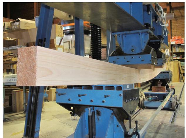
図-3 実大曲げ試験機(前川試験機製作所製、最大容量1,000kN)による曲げ強度試験
