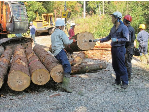
図-2 縦振動法による原木丸太の動的ヤング係数測定
