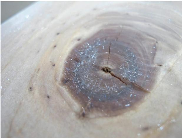
図-12 節の周辺の成長点痕跡 (小孔) と節に析出したセドロール結晶
