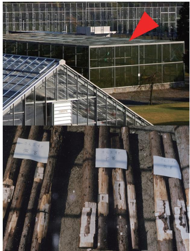
図-2 検定網室と検定木の被害調査
